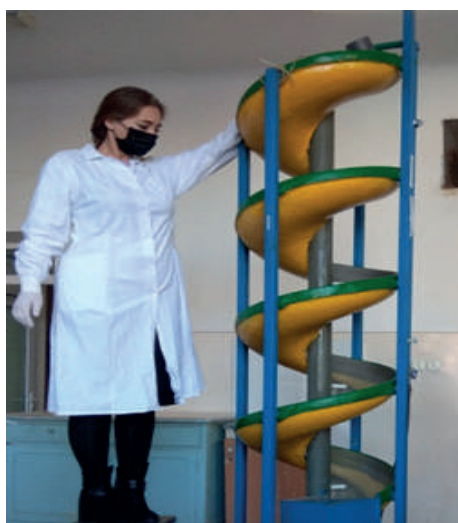
1-расм Винтли сепараторда бойитиш жараёни
