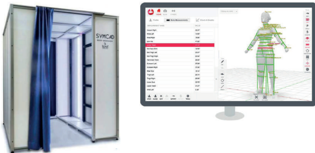
1-расм. 3D боди сканернинг кўриниши ва сканерланган одам ўлчам кўрсаткичларининг экранда кўриниши
