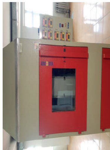
Рисунок 3. Установка «Шахтная печь» по ГОСТ 30244
